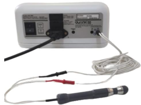
\*O **Eletrodo Vaginal** possui 2 pares de anéis que podem ser utilizados. Os **anéis externos** podem ser usados através do **cabo branco no canal 1** e os **anéis internos** podem ser utilizados através do **cabo cinza no canal 2**.
