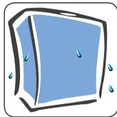
O freezer horizontal quando instalado em locais com umidade relativa do ar acima de 75% é normal que o Freezer apresente condensação externa (suor).
