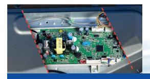
As placas eletrônicas são revestidas com tripla camada de resina protetora anticorrosão, ocasionadas pela maresia e umidade.
