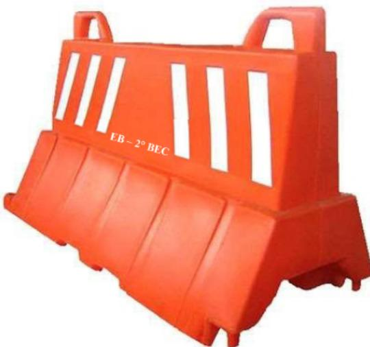
Fabricada em polietileno, de baixa densidade, com proteção contra raios UV, resistente a intempéries (sol e chuva), com 55 cm de altura X 1 m de comprimento X 50 cm de largura, com refletivo adesivo, de alta visibilidade, dos dois lados da peça. Possui orifício para encaixe de sinalizador e 2 alças na parte superior, para fácil transporte, possui gavetas de areia (inclusas), para serem acopladas na parte interna da base. Peso sem enchimento de areia 7,0 kg e com enchimento de areia 18 kg.
