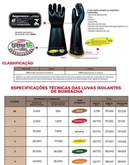
Luva isolante de borracha natural/sintética, tipo II, classe 1. Comprimento: 356 mm. Resistência de: 10000V. Tensão de uso: 7500V. Prod. por: Imersão. "ESTE EQUIPAMENTO DEVERÁ APRESENTAR O SELO DE MARCAÇÃO DO INMETRO".
