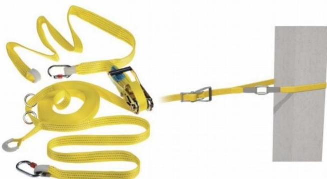
Linha de vida portátil fabricada em fita de poliéster de 50 mm, equipada com um dispositivo que permite regular o comprimento e tensionar a fita facilmente. Comprimento regulável entre 2,5 a 20 metros. Certificada para 2 usuários. Equipado com 2 mosquetões AM002, 2 anéis de ancoragem em aço forjado, 2 fitas de ancoragem em poliéster com 35mm de largura e comprimento de 2 m e uma bolsa em poliéster, que serve para armazenar o excesso de fita e usado para transporte.
